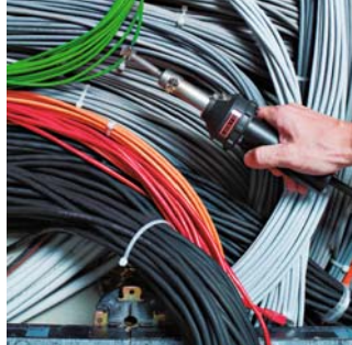
Smršťování elektroizolace pomocí děrovaného reflektoru na přístroji HOT JET S.
